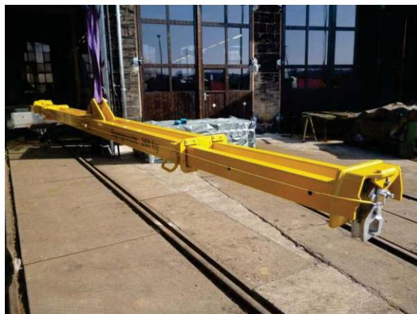
Ce palonnier télescopique à rails est destiné à la manutention de rails élémentaires jusqu'à 25m de longueur.
