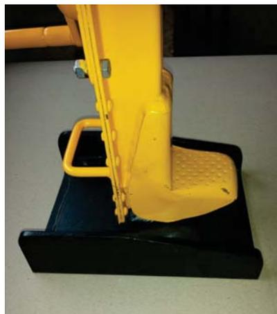
Le cric à fut montant permet le relevage du rail pour des travaux de renouvellements, de pose de voies neuves, de bourrage, d'entretien, etc.
