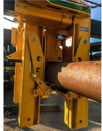
La pince modèle 152 a été conçue pour la manutention de poteaux de diverses sections, poteaux caténaire ou mâts d'éclairage, pour un fonctionnement **en toute sécurité**.
